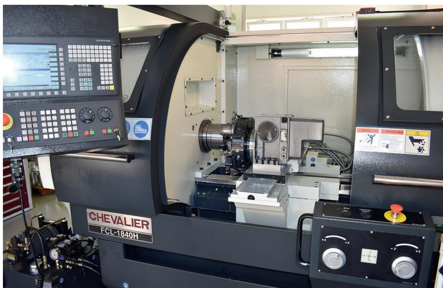
1 Die Chevalier FCL-1840H bei Müller-Mechanik wurde vom Vertriebs- und Servicepartner Hommel Maschinentechnik in Bochum mit einem 8-fach-Revolver und hydraulischem Spannfutter kundenspezifisch aufgerüstet © Hommel
